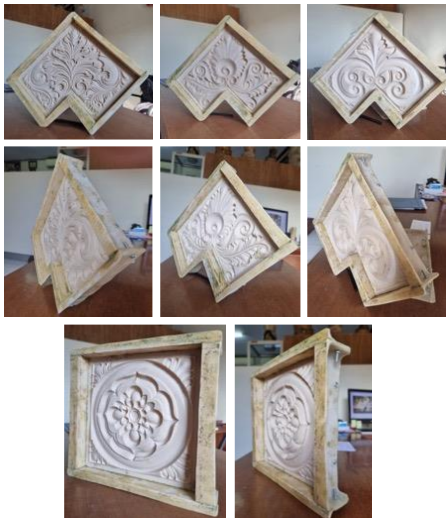
Gambar 13. Cetakan Negatif Ukiran berbahan fiber glass [Sumber : Tim Peneliti, 2022]
