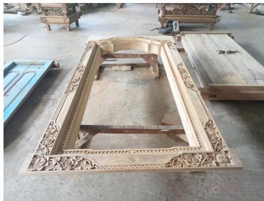
Gambar 12: Proses Perakitan Pintu Kuwadi Spesifikasi Luh (Sumber: Putra Suryadana, 2022)
