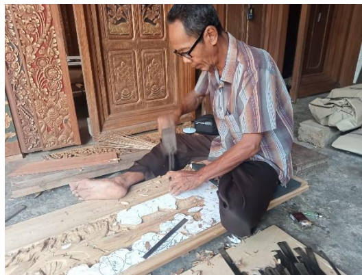
Gambar 10: Proses Pembakalan Daun Pintu Kuwadi (Sumber: Putra Suryadana, 2022)
